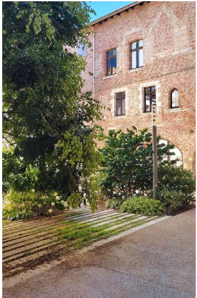
Désimperméabilisation et végétalisation d'une placette au sein du site patrimonial remarquable place Saint-Priest Cahors (46) Conception : Palimpseste / réalisation : régie ville de Cahors
