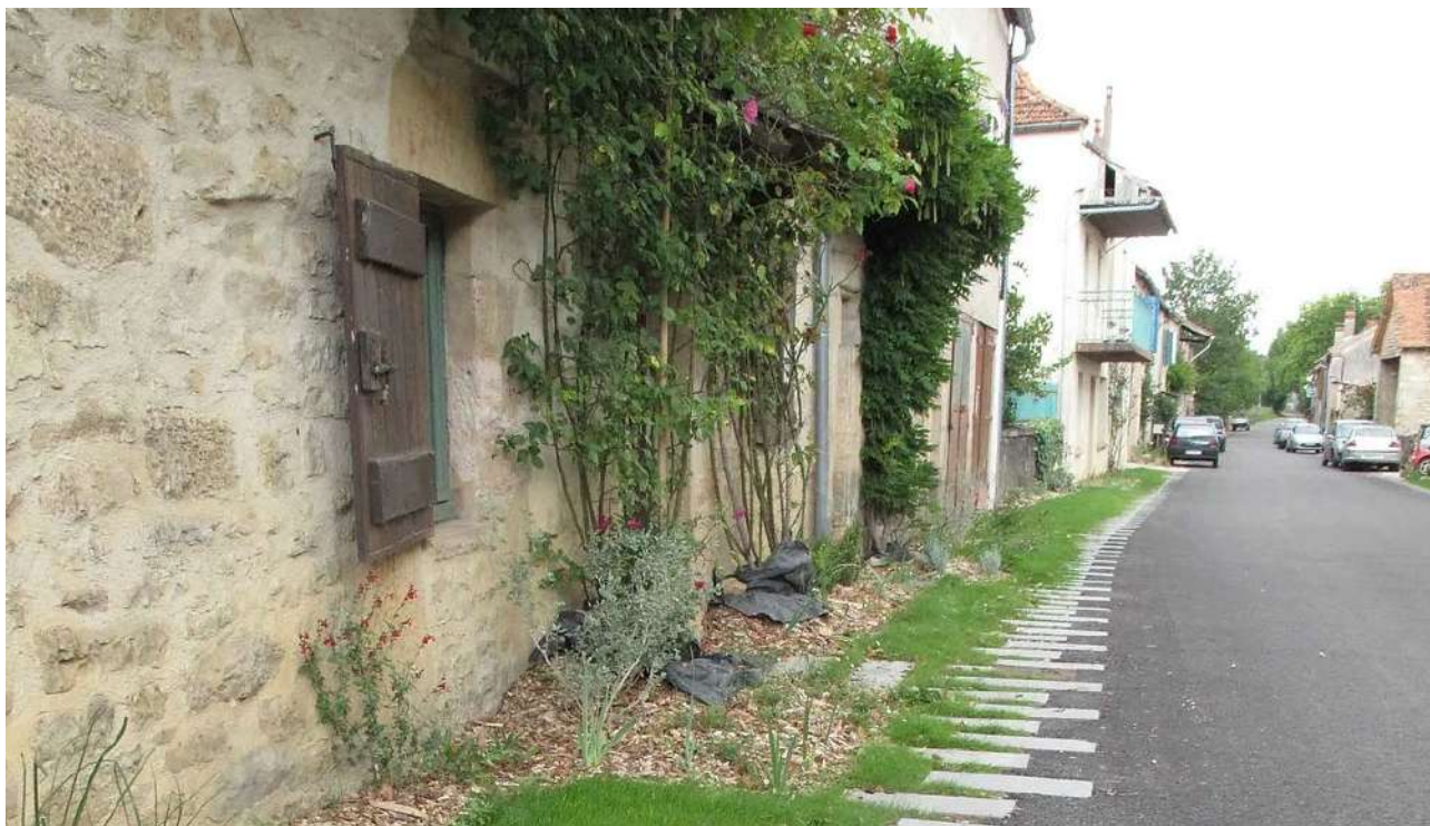
Végétalisation de la traverse de village à Beauregard (46). Le profil bombé de la chaussée dirige les eaux de ruissellement de part et d'autre ; le paillage supprime l'arrosage et le désherbage ; les vivaces et grimpantes en pied de porte suscitent un investissement des riverains. MOE : Atelier Palimpseste © Guillaume Laizé
