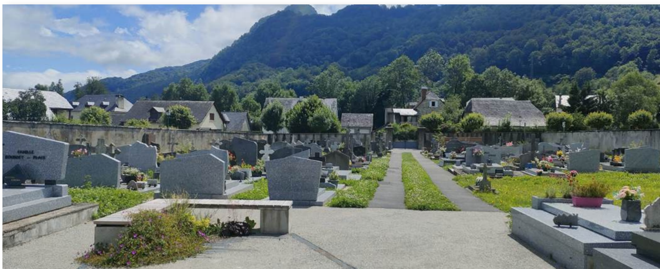
Création d'une allée carrossable mixte végétal/minéral et d'une placette d'entrée avec mobilier et vivaces, enherbement sur gravier (hydromulching) à Arrens-Marsous (65) © Territori paysagistes concepteurs
